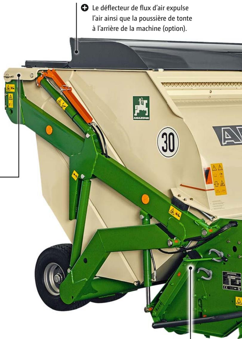
⊕ Le déflecteur de flux d'air expulse l'air ainsi que la poussière de tonte à l'arrière de la machine (option).
