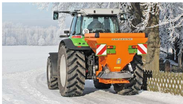
Epandeur hivernal E+S, capacité 300–1.000 l
