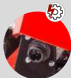
Prise pour équipements portés pour l'accouplement électrique Équipements portés contrôlables
