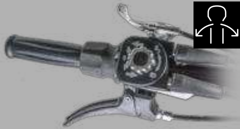
Draaiknop voor traploze snelheidsregeling vooruit en achteruit
