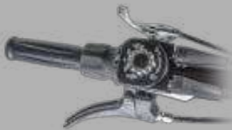
Draaiknop voor traploze snelheidsregeling vooruit en achteruit
