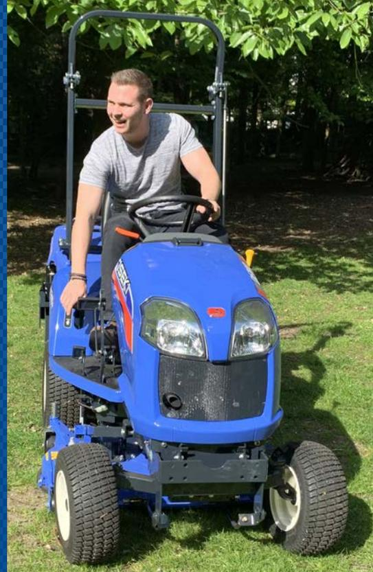
La tondeuse Iseki SXG216<sup>+</sup> est équipée d'un tableau de coupe de 102 cm avec éjection arrière. La SXG323<sup>+</sup> est dotée d'un tableau de coupe de 122 cm avec éjection arrière, la SXG326<sup>+</sup> est disponible avec des largeurs de coupe de 122 cm ou de 137 cm avec éjection arrière et est disponible en version mulching d'une largeur de 137 cm.
