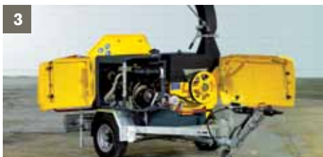
3- SERVICEKAPPEN snel en gemakkelijk bereikbare onderhoudsplaatsen
