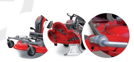
GSR + Electric permet également d'avoir l'option D'ÉJECTION PAR L'ARRIÈRE. Cette fonction peut être obtenue en retirant simplement un obturateur en aluminium placé sous le carter de la tondeuse grâce à un levier simple et rapide, pouvant être actionné manuellement du côté droit (côté conducteur).
