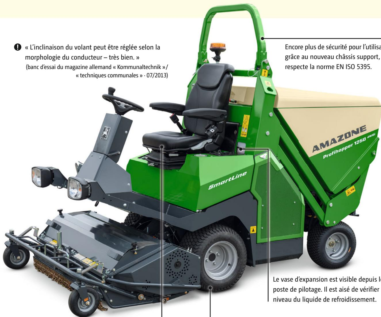
Le vase d'expansion est visible depuis le poste de pilotage. Il est aisé de vérifier le niveau du liquide de refroidissement.
