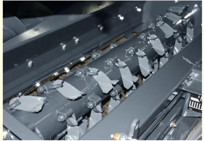
❗ « L'unité de tonte coupe l'herbe très proprement et le produit de la tonte est convoyé par l'intermédiaire des vis sans fin dans la benne gros volume, ceci même en conditions humides. »
