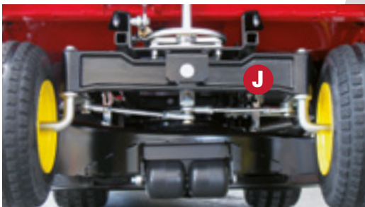
J Essieu monobloc en acier forgé
