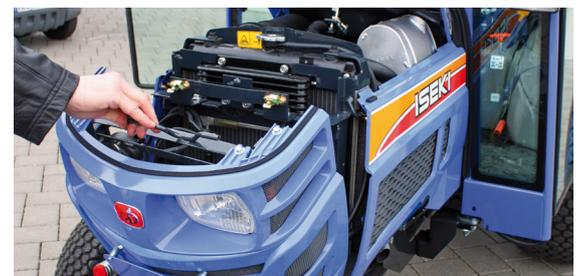
Les panneaux latéraux du capot moteur sont en acier haut de gamme. L'isolation sur leur envers réduit le bruit audible de l'extérieur.
