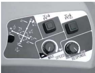
POTENTIOMETERS VOOR DE INSTELLING VAN HET REACTIEVERMOGEN VAN DE TRANSMISSIE EN HET BEPERKEN VAN DE MAXIMALE SNELHEID. DRUKKNOPPEN VOOR HET INSCHAKELN VAN DE CRUISE CONTROL OF DE MEMORY CRUISE CONTROL
