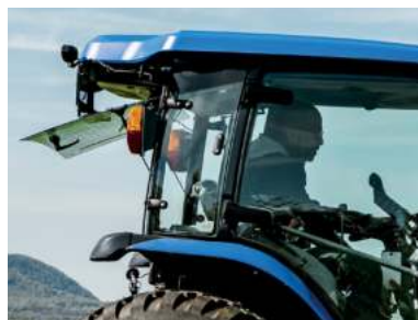
ACHTERRUIT EN ZIJRUITEN VAN DE CABINE KUNNEN WORDEN OPENGEKLAFT
