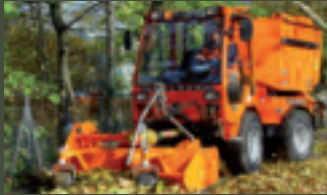
Trommelmaaier met afzuiginstallatie
