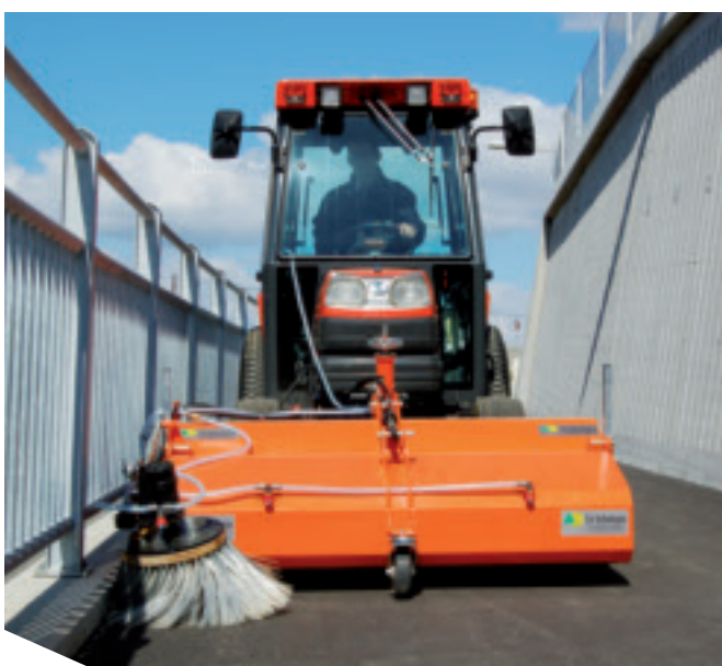
Veegmachine S – reiniging brug
