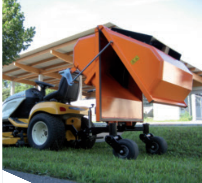
Manuele leging met gasdrukcilinder
