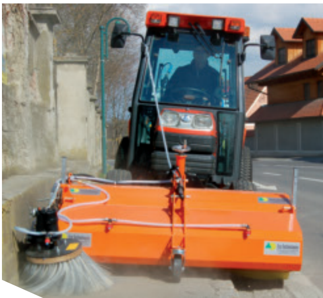
Veegmachine S – met derde loopwiel
