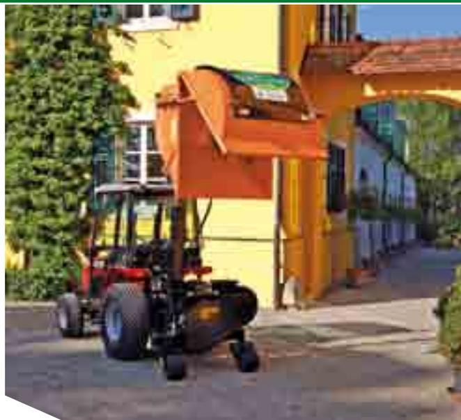
Vidange en hauteur grâce à un tube télescopique (jusqu'à 2.03 m)
