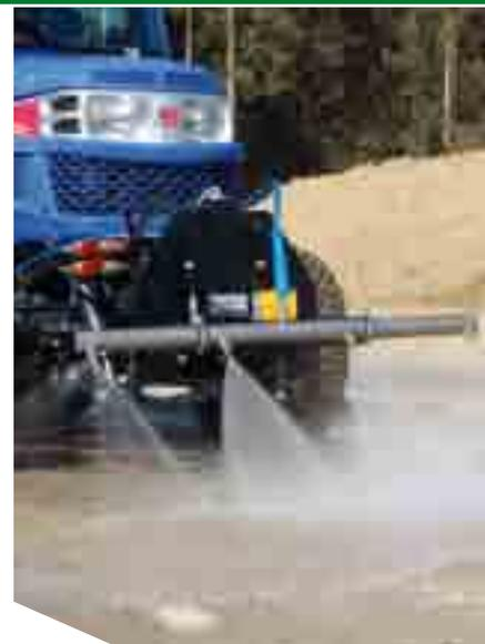
réglage optimum de la barre d'épandage selon le type de nettoyage à réaliser.
