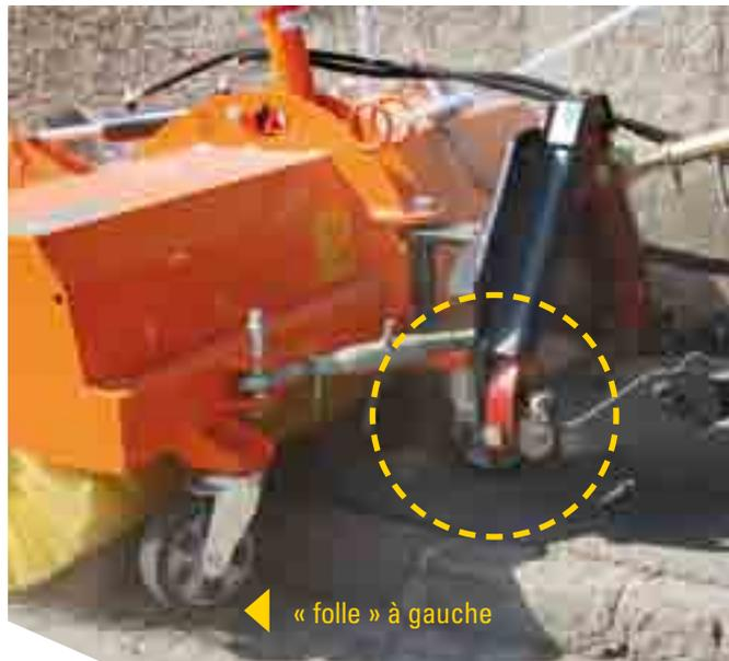
3ème roue d'appui au centre pour compenser roue « folle » à gauche
