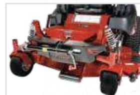
**Kit de pare-chocs avant.** Avec éclairage LED 2x 6 watt intégré, support de poids avant et cric de service (Cric de service vendu séparément).
