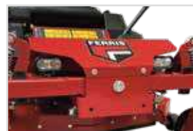
LED lichte - vooraan 2 x 6 watt energie-efficiënte LED lichten vooraan.
