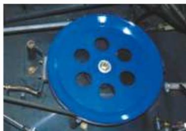
**TRANSMISSION LAME PAR COURROIE AVEC POULIE À AILETTES**
