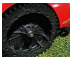
Roue dentée autonettoyante
