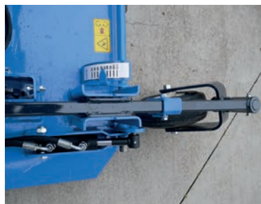
OPTIONEEL KAN DE MAAIHOOGTE OOK HYDRAULISCH VANOP DE BESTUURDERSPLAATS WORDEN GEREGLD
