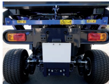
ROBUUSTE ACHTERAS MET GIETIJZEREN HAAKSE TRANSMISSIE
