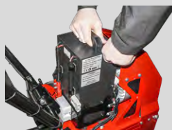
Batterij snel en zonder gereedschap te vervangen
