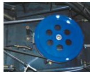
Transmission de lame par courroie avec poulie à ailettes.
