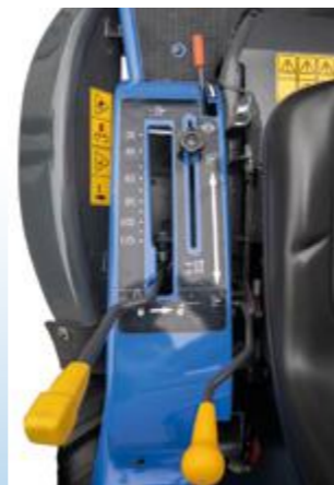
Réglage hauteur de coupe à 10 positions.
