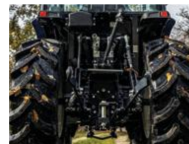
3-PUNTSHEF Hefstelsysteem achteraan van 1200 kg en bediening aftakas op spatbord
